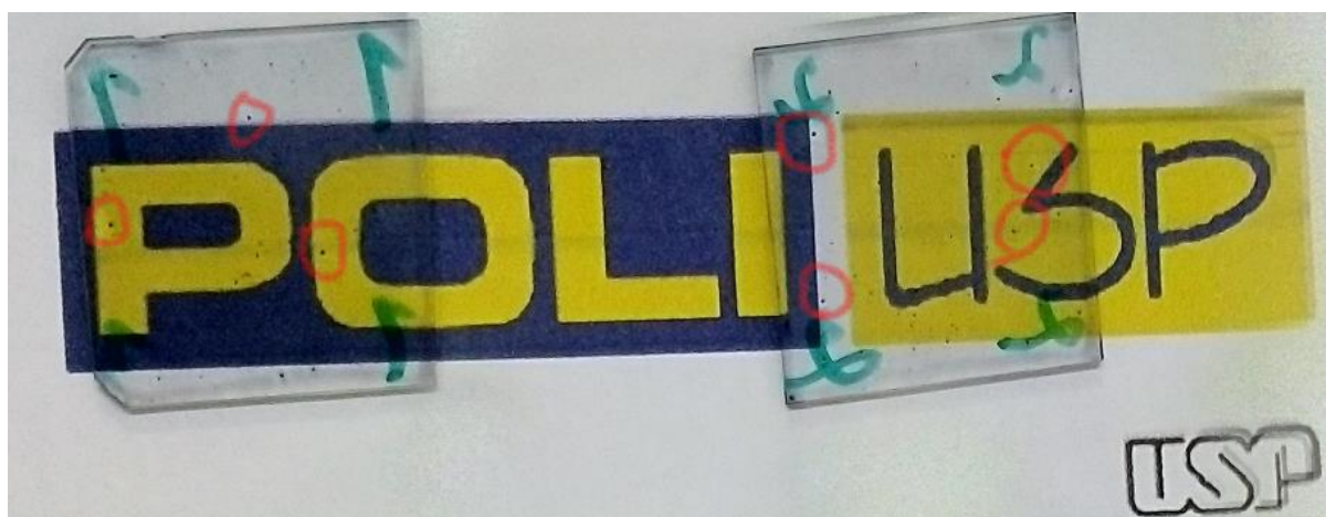
Figura 31 - Detalhe das lâminas 1 e 2 da 7ª Sequência. Alguns dos pontos escuros citados estão destacados por círculos vermelhos [Autorial]
