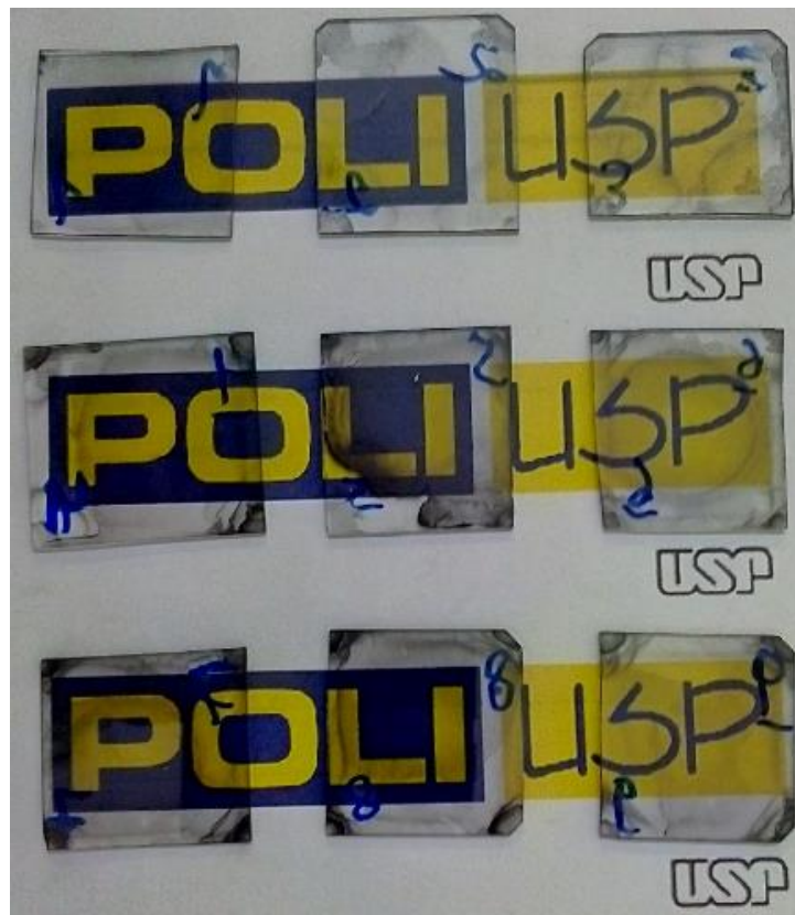
Figura 24 - Filmes com uma (primeira linha), duas (segunda linha) e três (terceira linha) camadas depositados na Sequência 2. [Autorial]
