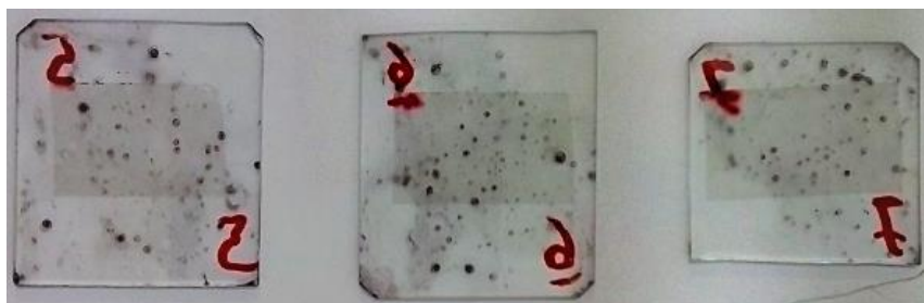
Figura 23 - Filmes com três camadas depositados na Sequência 1. [Autoral]
