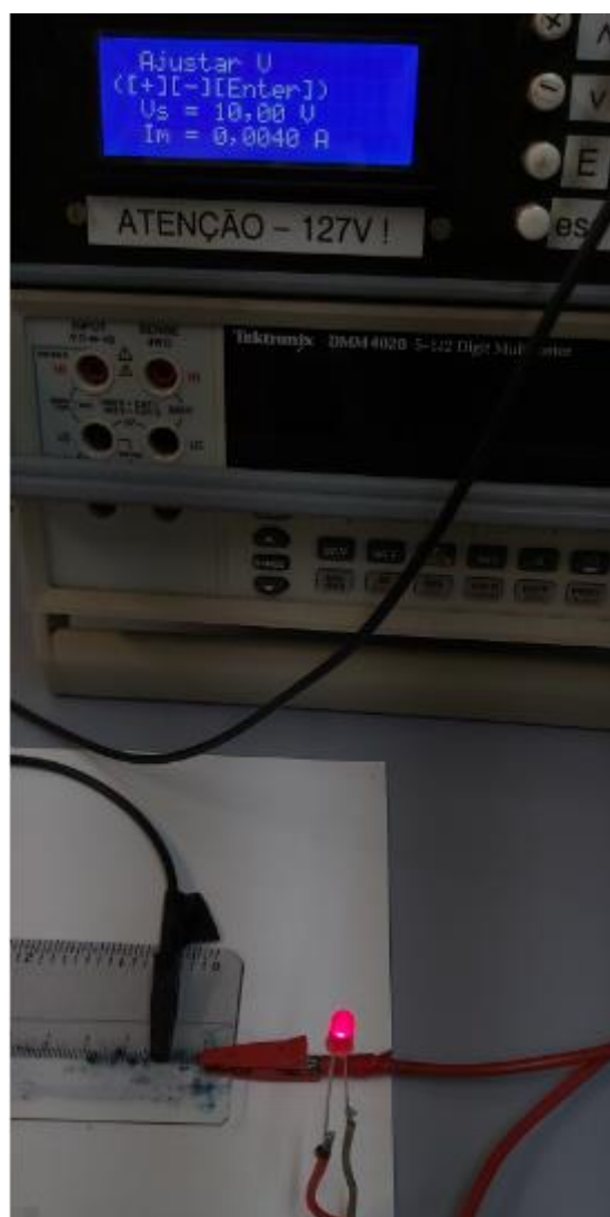
Figura 57 - Dispositivo formado por trilha na lâmina 2 e LED aceso com aplicação de tensão, mostrando também a corrente desenvolvida (4 mA) sob 10V. [Autorial]
