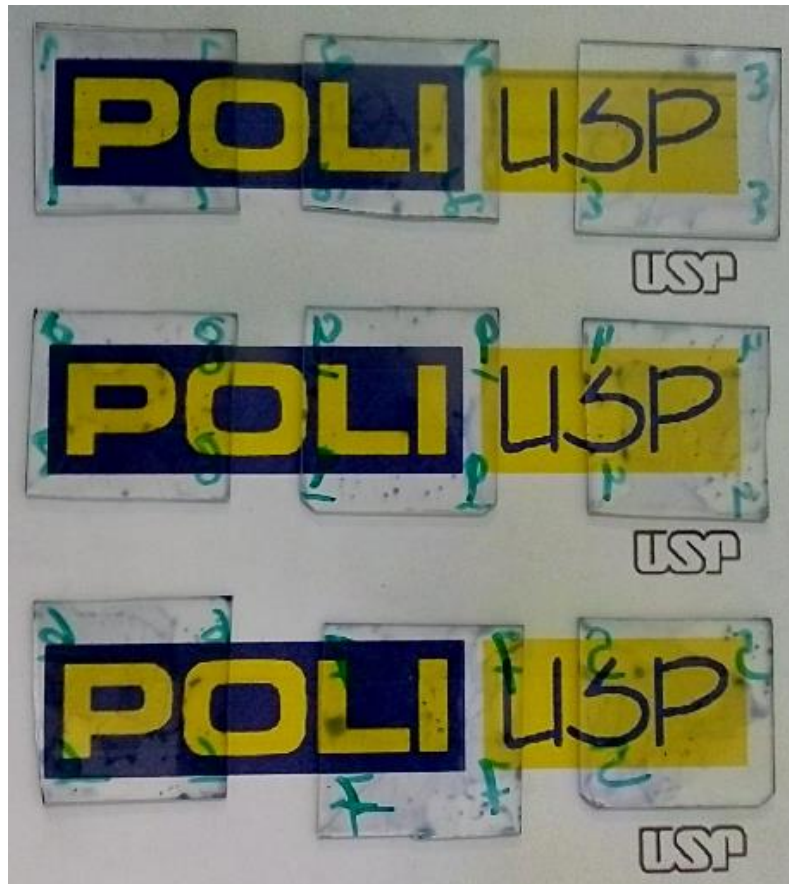
Figura 32 - Filmes com uma (lâminas 1, 2, 3 e 8), duas ( lâminas 4, 6 e 7) e três ( lâmina 5) camadas depositados na Sequência 8. [Autorial]
