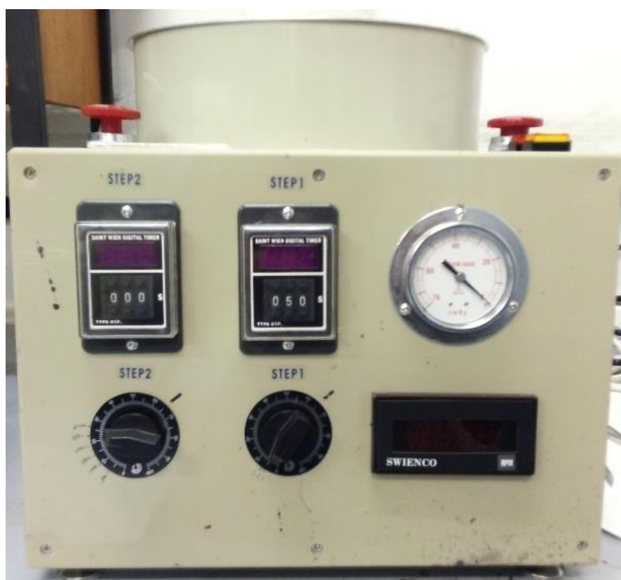
Figura 11 - Spin-coater usado para depositar os filmes [Autorial]
