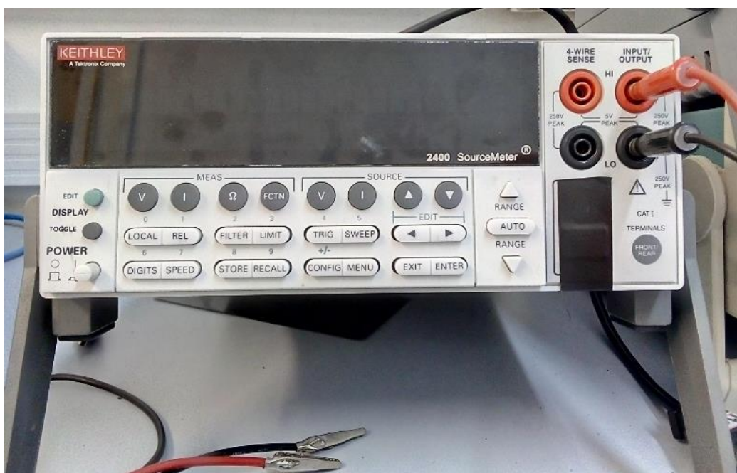
Figura 16 - Multímetro e garras-jacaré utilizados na medição das resistências [Autorial]
