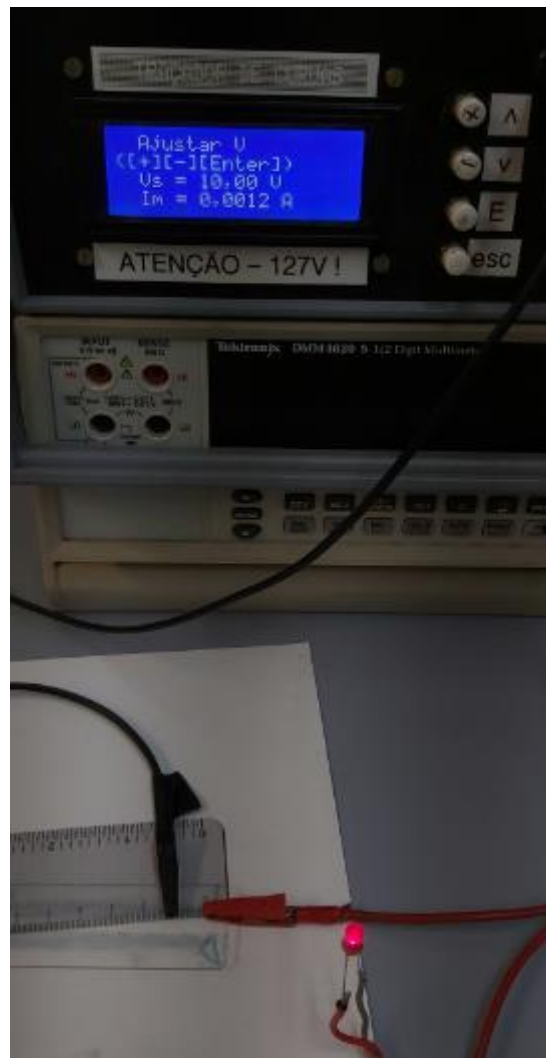
Figura 55 - Dispositivo formado por trilha na lâmina 1 e LED aceso com aplicação de tensão, mostrando também a corrente desenvolvida (1,2 mA) sob 10V. [Autorial]
