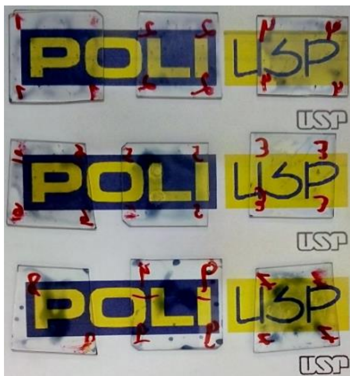
Figura 29 - Filmes com uma camada (exceto 7, com duas) depositados na Sequência 6. [Autorial]
